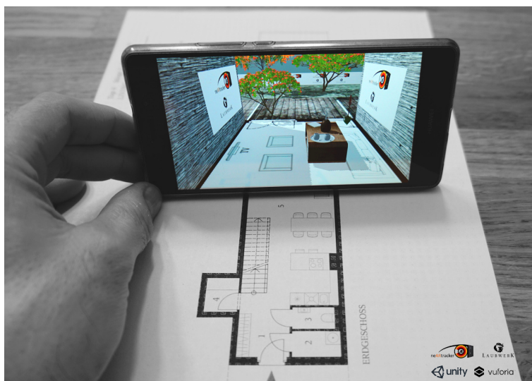
FIGURE 2.7 – Vuforia : exemple de RA par marqueur
